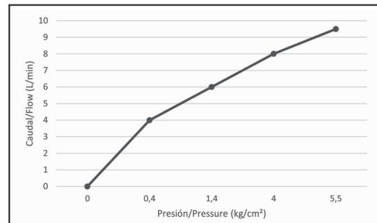
FV garantiza el funcionamiento hasta 4 kg/cm<sup>2</sup>
