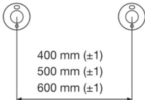
**4** - Una vez fijado el soporte B, sin roseta proceda a la fijación del segundo soporte B, respetando las distancias entre centros (400, 500 ó 600 mm según corresponda) y manteniendo la horizontalidad del conjunto.
