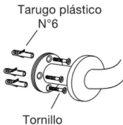
**3** - Fije el soporte a la pared mediante los tarugos plásticos y los tornillos provistos con el juego.
