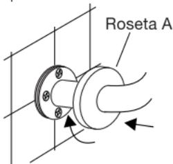
**5** - Finalmente deslice la roseta A hacia el soporte B enroscándolo como indica la figura.
