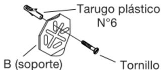
**3** - Fije el soporte a la pared mediante los tarugos plásticos y los tornillos provistos con el juego. Repita el procedimiento (pasos 1 y 2), finalizando la fijación del soporte.
