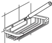
**1** - Ubique el accesorio (en la posición que indica la figura) para marcar el lugar donde se realizarán los agujeros para la fijación del mismo, verificando la horizontalidad.
