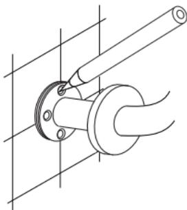
**1** - Ubique el accesorio (en la posición que indica la figura) para marcar el lugar donde se realizará el primer agujero para la fijación del mismo y verificando la horizontalidad.
