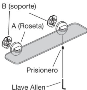
Para la colocación de la repisa, repita las operaciones 1, 2, 3 y 4 de los accesorios con 2 soportes, para la correcta instalación tenga en cuenta la horizontalidad de la misma y la medida entre centros.
