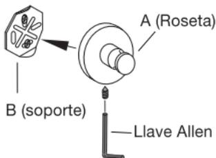
**4** - Una vez fijado el soporte B, ubique sobre el mismo la roseta A, como indica la figura. Ajuste la misma con los tornillos prisioneros, utilizando la llave Allen (provista con el juego) para lograr una correcta fijación del accesorio.
