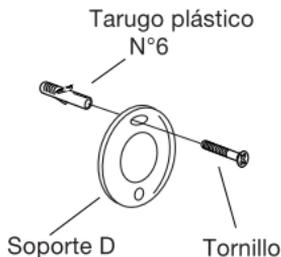
**3** - Fije el soporte D o B a la pared mediante los tarugos plásticos y los tornillos provistos con el juego.
