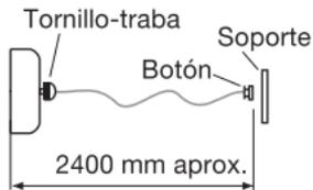
Fije el tender y el soporte a la pared verificando su horizontalidad y teniendo en cuenta que su extensión máxima es de 2400 mm aproximadamente. Para usar el tender tire de la sogá y enganche el botón en el soporte fijado en la pared opuesta. Gire el tornillo-traba del cuerpo en el sentido de las agujas del reloj para mantener la sogá firme en el uso. Para guardar la sogá, desengánchela del soporte y afloje el tornillo-traba del cuerpo. La sogá se enrollará automáticamente.
