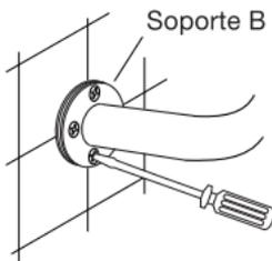
**4** - Una vez fijados los tornillos del soporte B con un destornillador, repita la operación con el segundo soporte.
