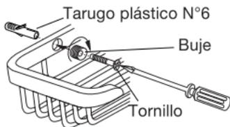
**3** - Ubique el accesorio en la pared, coloque los bujes y luego ajuste el accesorio con los tornillos provistos con el juego.
