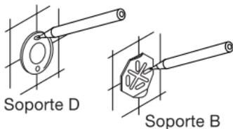
**1** - Use un soporte B o D, según el accesorio, (en la posición que indica la figura) para marcar el lugar donde se realizará el primer agujero para la fijación del mismo.
