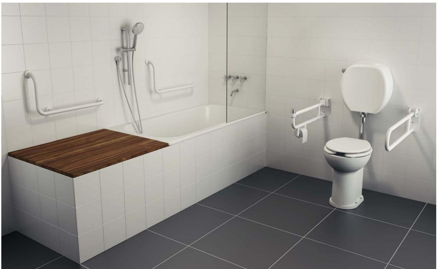
El inodoro de la **Línea Espacio** cuenta con un diseño que respeta la relación de altura con la silla de ruedas. Su pedestal –de 50 cm de alto– no necesita de ningún tipo de suplemento, y la transferencia desde la silla se realiza de manera directa y con absoluta seguridad. Posee cuatro fijaciones al piso que le permiten soportar los esfuerzos laterales producidos por dicha transferencia y los eventuales golpes que, en esas circunstancias, pueden producirse.
