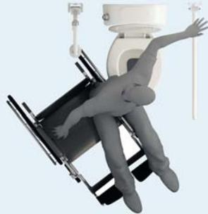
Levanta la barra abatible y se toma de la barra fija.
