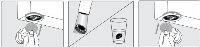
Coloque una moneda en la ranura que posee el aireador y desenróquelo. With a coin remove the aerator turning it counterclockwise.
