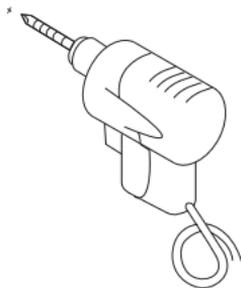
3\_ Realice el agujero con una mecha diámetro 6 mm y coloque el tarugo plástico N° 6.
