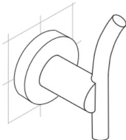
4\_Fije el soporte a la pared mediante uno de los tornillos provistos.
