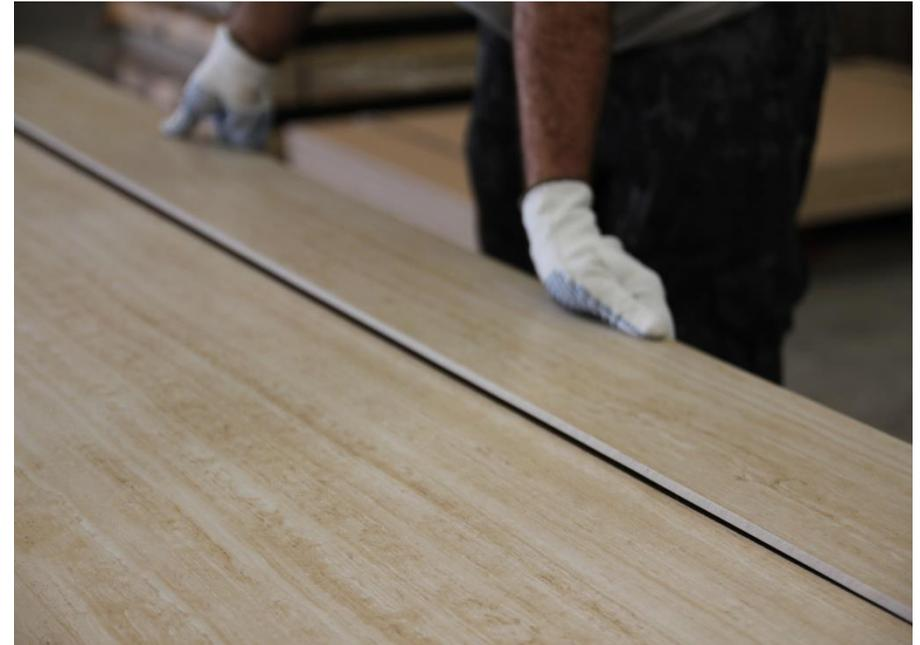
**Emplear la misma tenaza de corte como base en uno de los laterales de la pieza. Ejercer una leve presión en la parte central y retirar la pieza sobrante.**
