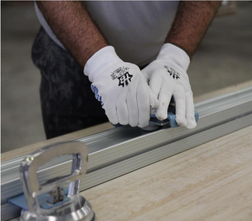
**Continuar el corte a lo largo de toda la pieza manteniendo siempre la misma velocidad y presión de corte.**
