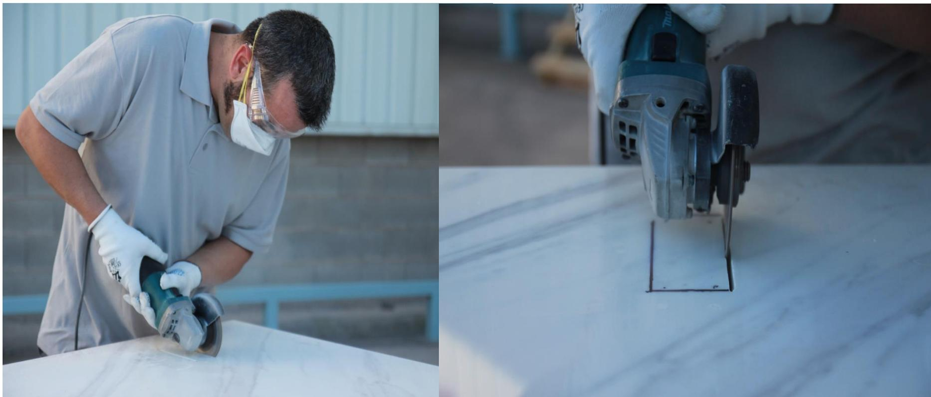
**Emplear un taladro con punta diamantada de unos 6-7mm e incidir en la pieza con un ángulo aproximado de unos 75°. Posteriormente, marcar la superficie con la punta diamantada ejerciendo una presión constante y haciendo oscilar lentamente el taladro. Es importante mantener mojada bien la punta diamantada o bien la lámina BPlus.**
