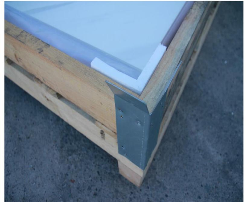
Las láminas B|PLUS se colocan y se embalan sobre cajones de madera de dimensiones 253x133x36. Los cajones contienen una base de madera en el fondo sobre la que se coloca 1 lámina doble de porexpan de 1cms y de densidad 10. Las esquinas, se refuerzan en el interior del cajón con porexpan y en el exterior con cantoneras metálicas.
