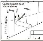
Armar sopapa y colocar curva. Lubricar y enchufar caño, marcar contra el borde del bidet (2da marca **B**).
