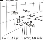
6 Lubricar y ensamblar caño de descarga.
