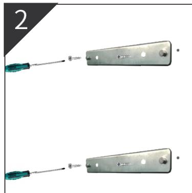
2. Coloque los chazos de expansión y fije la base con los tornillos
