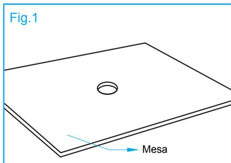
1. Perfore un orificio en la parte superior de la mesa en donde vaya a colocar el drenaje del lavamanos. Fig.1
